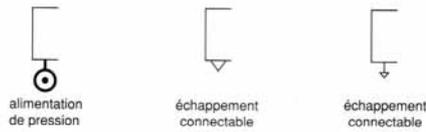
auxiliaires de distribution et canalisation
